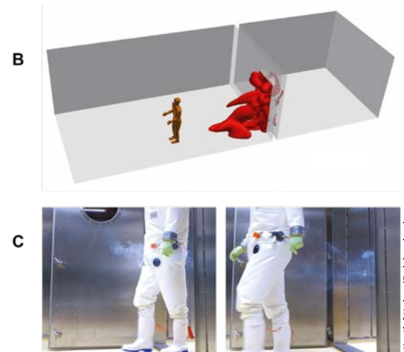
Abb. 3: Eine Person geht zwischen benachbarten Laborräumen innerhalb eines technisch luftdichten S4-Labors. (A) Die Person „zieht“ Luft mit, wenn sie durch eine Türöffnung geht. (B) Simulation der Luft, die 15 Sekunden nach dem Durchschreiten einer Türöffnung in einen Raum gezogen wird. (C) Darstellung des Luftzugs durch eine Person, die von Raum 1 in Raum 2 geht und dabei Rauch verteilt, bevor die Person zu gehen beginnt.
