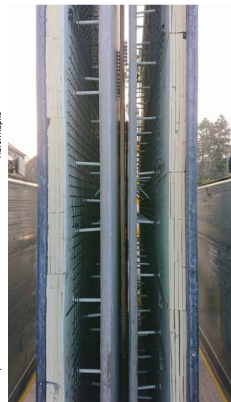
Der Aufbau der Elementwände ist hier deutlich sichtbar. Der Hohlraum wird erst auf der Baustelle im Ortbetonverfahren verfüllt.
