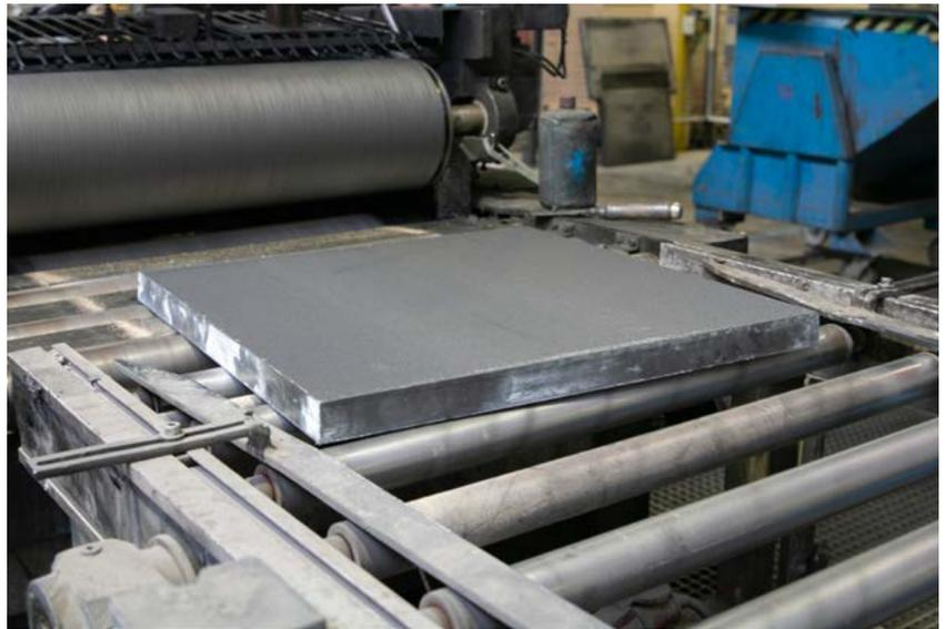
Nach der Demontage werden die Bodenplatten in den Lindner Werken auf Vorschädigungen geprüft und bearbeitet. Bild: www.Lindner-Group.com
