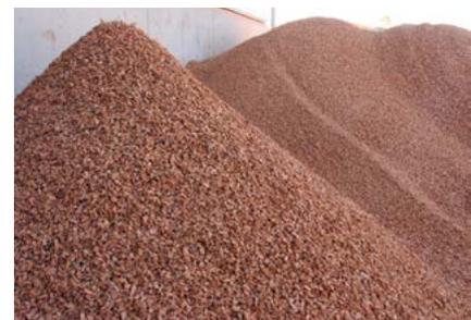
Da bei der Windsichtung Ziegelbruch in unterschiedlichen Körnungsgraden entsteht, kommt er auch facettenreich zum Einsatz. So findet er später z. B. als Dachbegrünung wieder Verwendung.
