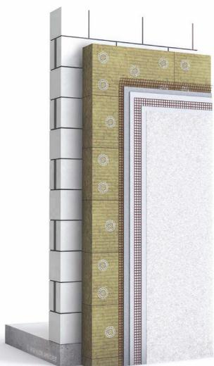
*Die funktionsgetrennte Bauweise ist langlebig. Ein Mauerwerk aus Kalksandstein bietet eine massive Basis, während ein vollmineralisches WDVS für Wärmeschutz sorgt und biozidfreie Oberputze vor Witterung schützen. Nachträgliche Änderungen der Dämmung oder Fassade lassen sich vornehmen, ohne dass in die tragende Konstruktion eingegriffen werden muss. Bild: wertvollewand.de*
