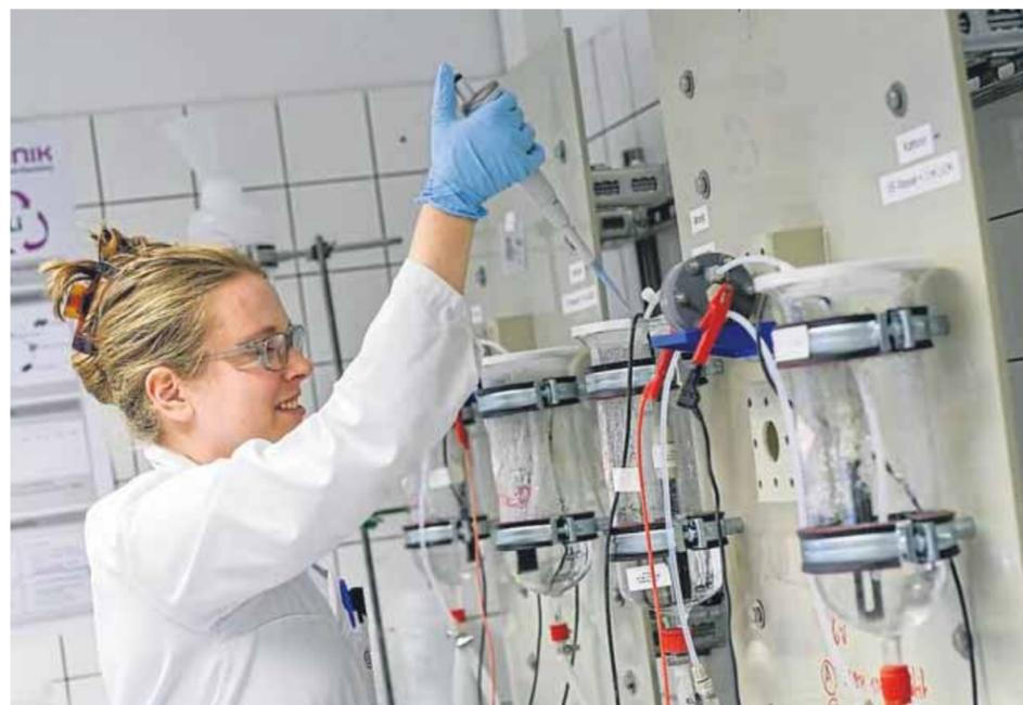
Am Versuchsstand: Doktorandin Laura Lennartz betreut die Versuchsstände zur Lithium-Ionen-Abtrennung bei Evonik in Hanau.
