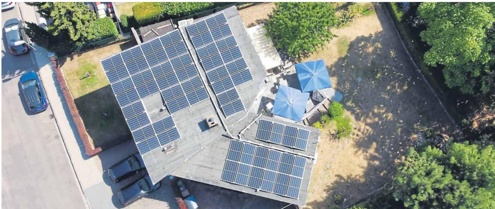
80 Prozent des Firmendachs, rund 175 Quadratmeter Fläche, sind mit PV-Modulen ausgestattet.
