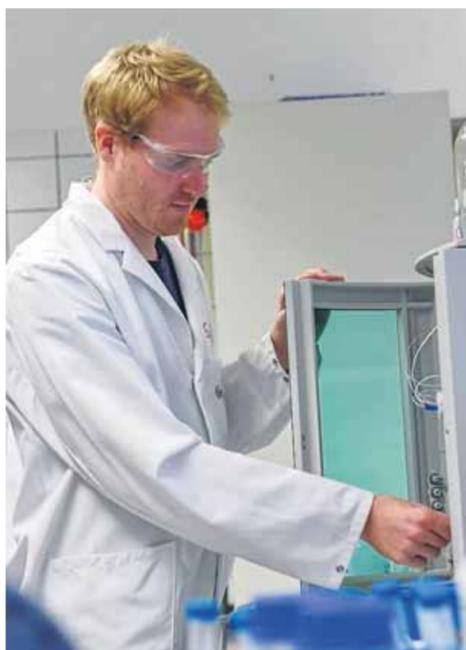
Sebastian Arndt bestimmt mit einer Ionenchromatographie die Konzentration des Lithiums im Elektrolyt.
