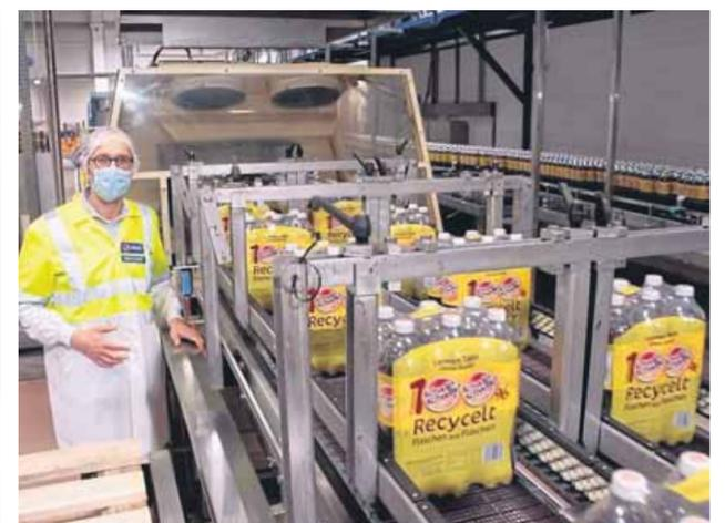
Hier kommen die folierten Sechserpacks Schwip Schwap gerade aus dem Schrumpftunnel.
